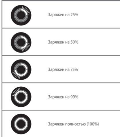
Устройство для нагревания табака glo™ должно заряжаться до 3,5 часов при комнатной температуре для полной зарядки.
