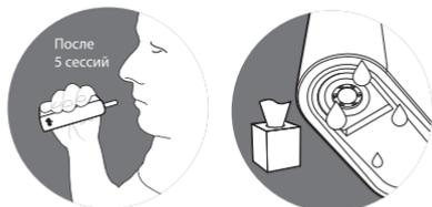
Для чистки внутренней части нагревательной камеры откройте затвор в верхней части и чистящую дверцу в нижней части устройства glo™.
